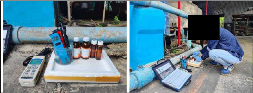
ภาพที่ 2 การเก็บตัวอย่างน้ำใต้ดินสถานีตรวจวัด GW 2 – JH ปอน้ำบาดาล (บ่อลึก) โรงงานพลาสติก TTP
